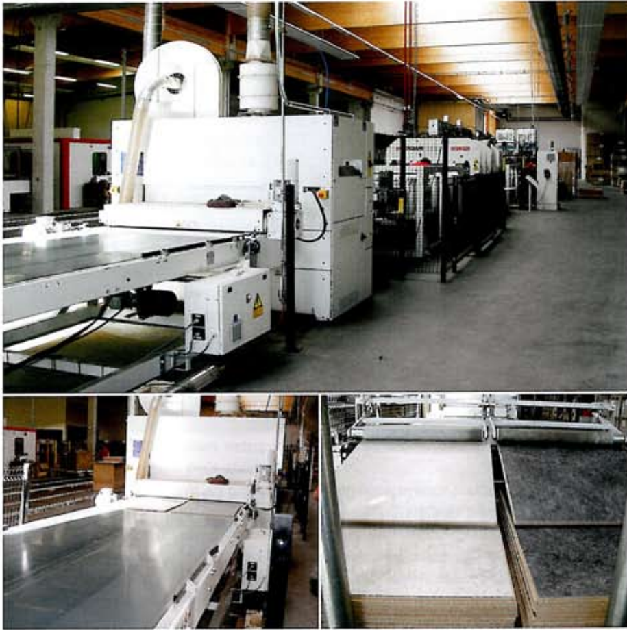
Die neue Halle in Müstair dient der Produktion von PVC-Designbelägen. Vinyl, HDF-Platte und Korkgegenzug werden verpresst.
